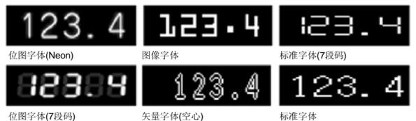
采用位图字体和Windows字体(图像字体)，可以清晰地显示数字字符。
