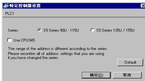
**注 释** • 使用 CPU945、CPU946、CPU947 或 CPU948 时，请勾选 [Use CPU945] 或 [Use CPU946/947/948] 复选框。根据所选的系列，复选框会相应改变。
