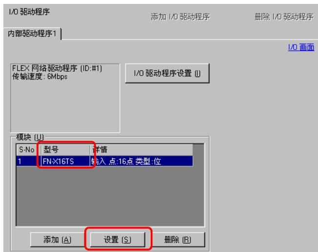
5 将弹出[模块设置]对话框。如需更改类型，在[类型]区选择 I/O 模块的型号。(例如，[输入 / 输出] 和 “FN-XY16SK”)。
