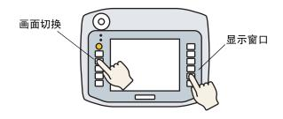
可以在手持式 GP 的局部功能键上设置常用开关和按键功能,局部功能键只在显示相关画面时有效。
