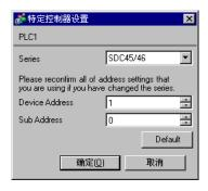
在配置外接控制器的通讯设置时,请使用控制器前面板上的 para、 enter、 display 及光标键。详情请参阅控制器的手册。
