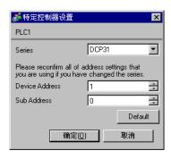
在配置外接控制器的通讯设置时,请使用控制器前面板上的 FUNC、 PARA、 ENT、 DISP 及  $\land$  和  $\lor$  键。详情请参阅控制器的手册。
