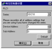
在配置外接控制器的通讯设置时,请使用控制器前面板上的 PARA、 ENT 及 $\land$ 和 $\lor$ 键。详情请参阅控制器的手册。
