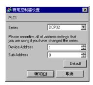
在配置外接控制器的通讯设置时,请使用控制器前面板上的 FUNC、 PARA、 ENT、 DISP 及  $\land$  和  $\lor$  键。详情请参阅控制器的手册。
