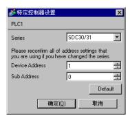
在配置外接控制器的通讯设置时,请使用控制器前面板上的 ENT、 DISP、 MODE 及 〈和 〉键。只有在 READY 模式下才能更改通讯设置。在设置前,请将外接控制器切换到 READY 模式。 详情请参阅控制器的手册。
