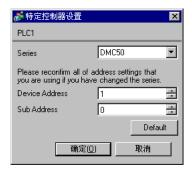
请使用梯形图软件 (Smart Loader Package SLP-D510 V2.2.3) 来配置外接控制器的通讯设置。使用控制器前面板上的旋转开关设置外接控制的寄存器地址。
