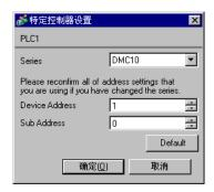
请使用梯形图软件来配置外接控制器的通讯设置。 (使用 Smart Loader Package SLP-D10 V3.0.1 的操作已经确认。)使用控制器前面板上的旋转开关设置外接控制的寄存器地址。 详情请参阅控制器的手册。
