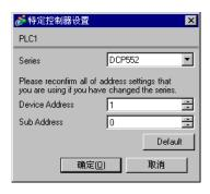
在配置外接控制器的通讯设置时,请使用控制器前面板上的 PROG、 RUN/HOLD、 SETUP、 ENT、 DISP 及〈和〉键。只有在 READY 模式下才能更改通讯设置。在设置前,请将外接控制器切换到 READY 模式。
