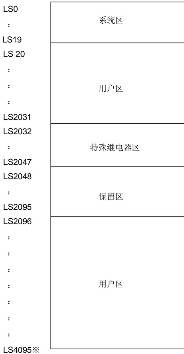
用户区是仅供 GP 内部使用的设备地址，不能在 PLC 内使用。这个区只能用于处理 GP 内部的部件和 Tag，PLC 不能控制。
